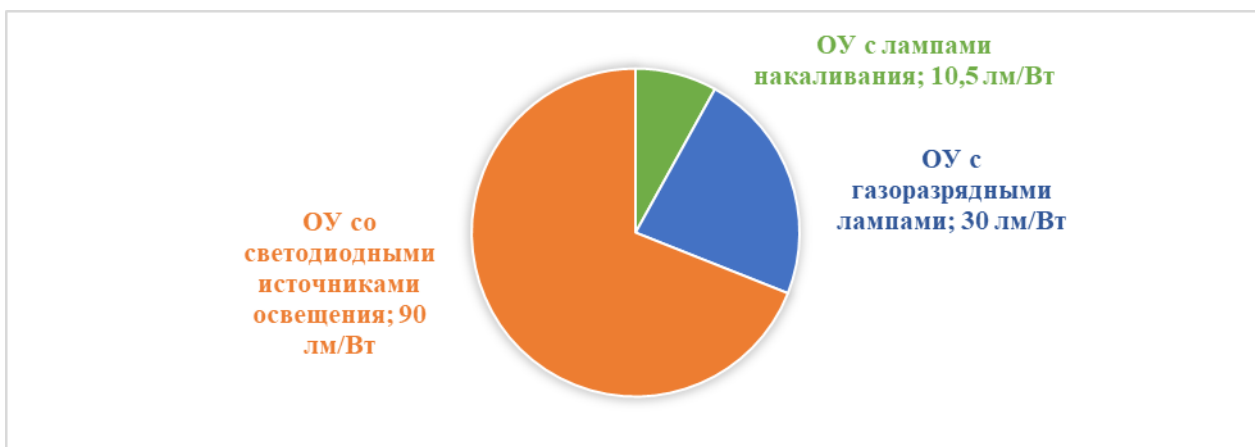
Рисунок 3 – Эффективность светоотдачи для ОУ с лампами накаливания, газоразрядными лампами и светодиодными источниками излучения
