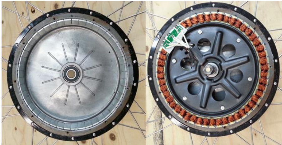
Рисунок 2 – Электромотор прямого типа
