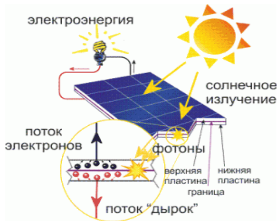
Рисунок 2 – Принцип работы солнечных панелей
