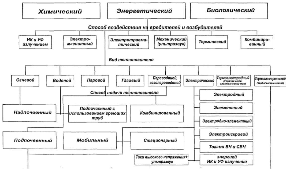
Рисунок 1 – Классификация энергетических способов и технических средств обеззараживания почвы
