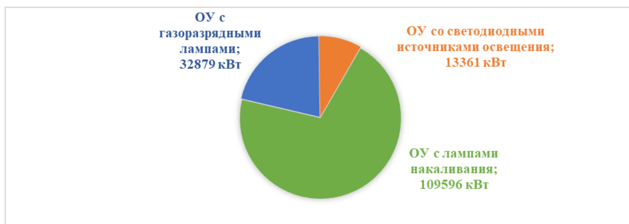
Рисунок 2 – Энергозатратность за год ОУ с лампами накаливания, газоразрядными лампами и светодиодными источниками излучения в помещении зернохранилища S = 1814 \text{ м}^2
