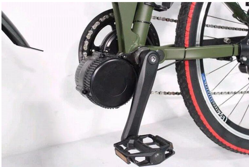
Рисунок 3 – Электромотор кареточного типа
