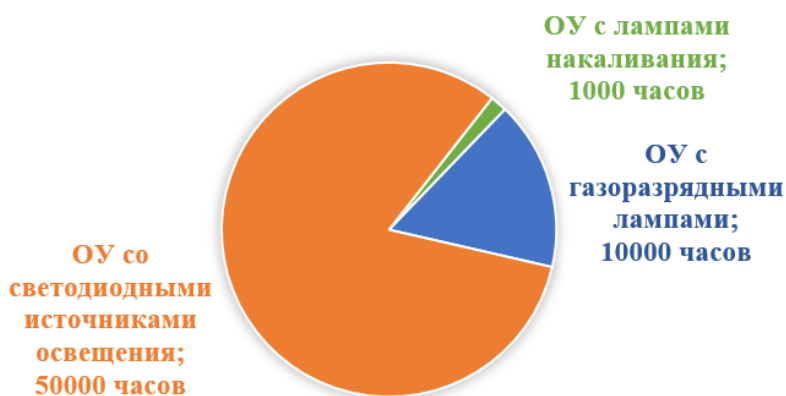
Рисунок 1 – Срок службы ОУ с лампами накаливания, газоразрядными лампами и светодиодными источниками излучения
